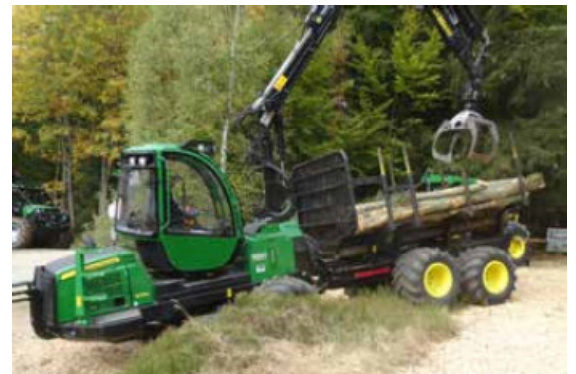
Forwarder sind geländetaugliche Spezialfahrzeuge zum Transportieren von Holz aus dem Wald. Mit dem ZÖFU-Gütezeichen wird ein nachhaltiger Einsatz bestätigt.
